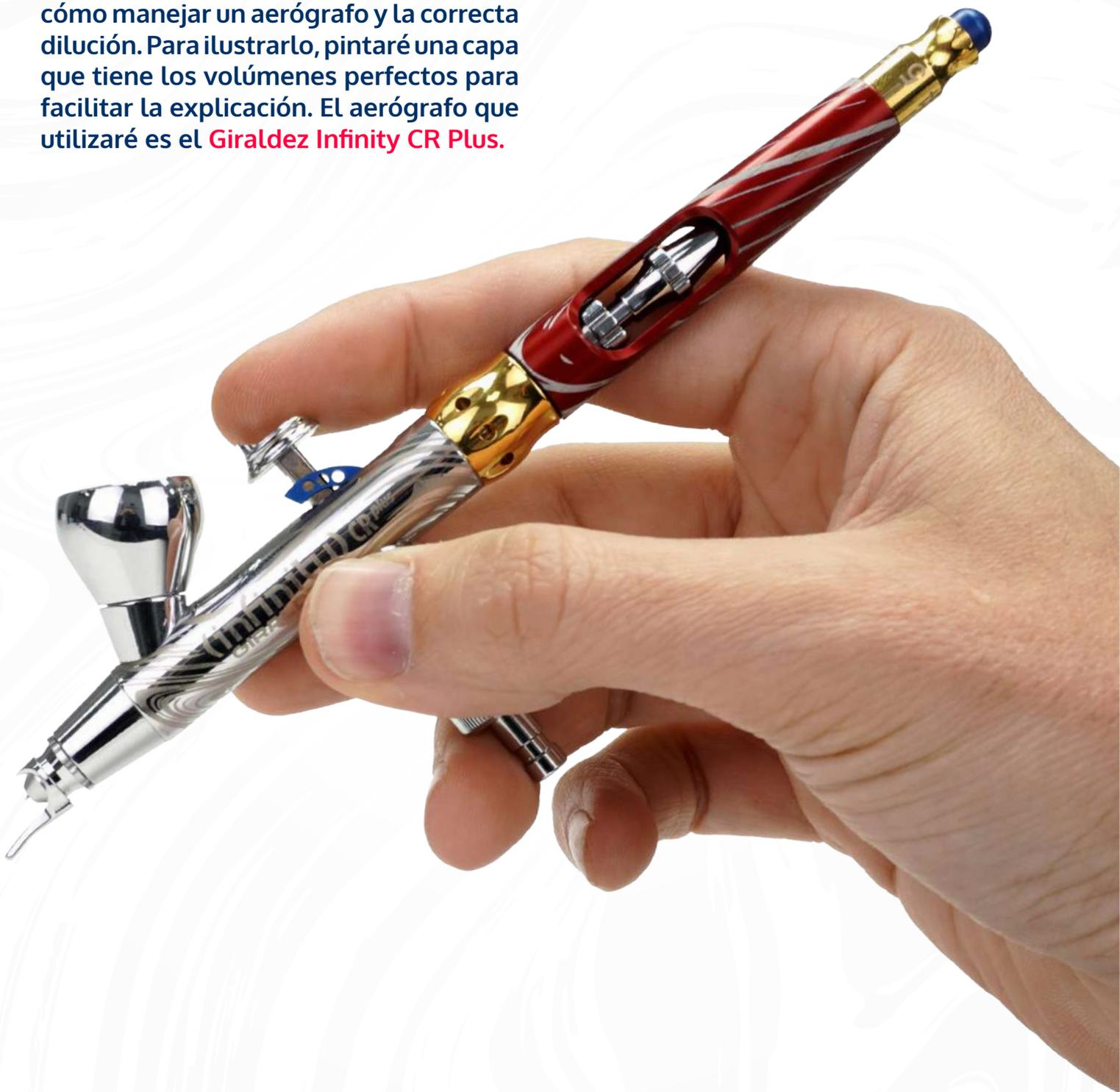
El **INFINITY GIRALDEZ** es un aerógrafo de doble acción, lo que significa que al presionar hacia abajo el gatillo se libera aire (1), y al tirar de él hacia atrás se libera pintura (2).
